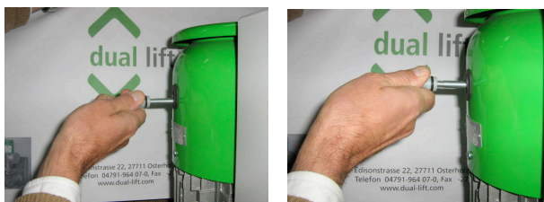
Actionnement de la descente manuelle sur le moteur
