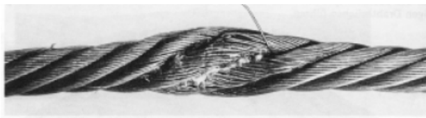
Câble métallique avec aplatissement dû à un véhicule
