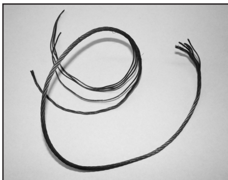
Écrasement et déformation du câble
