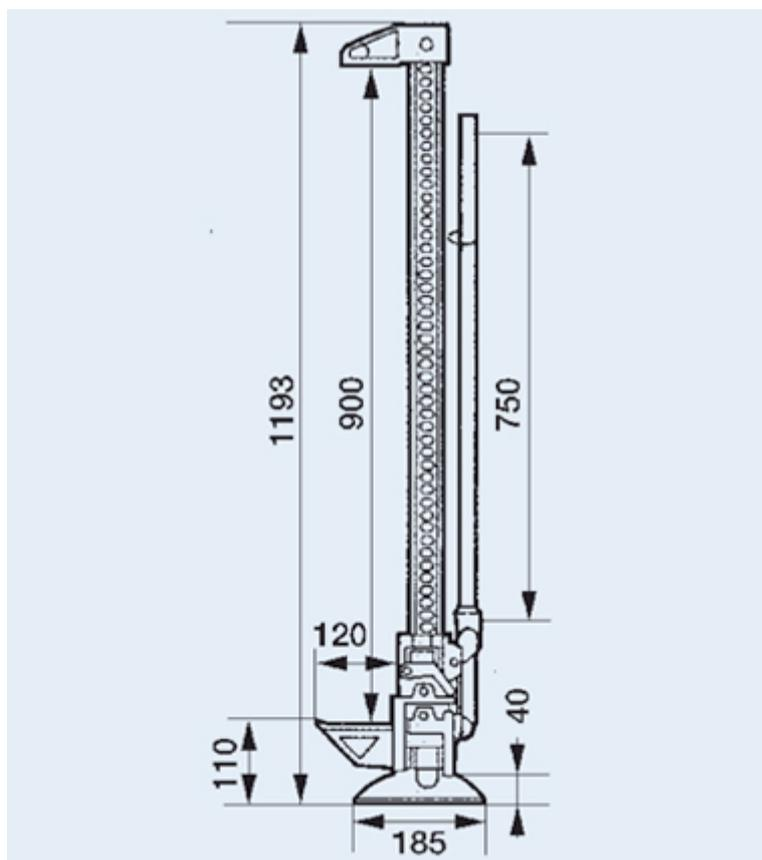
**CAPACITÉ : 2 tonnes en levage**
