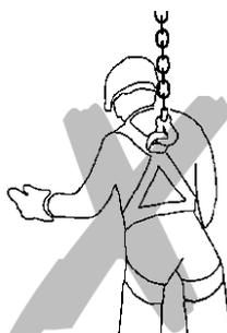
Il est interdit de faire des soudures sur le chariot en option, le ou les crochets et la chaîne de charge. La chaîne de charge ne doit jamais être utilisée comme ligne de mise à la terre durant le soudage.
