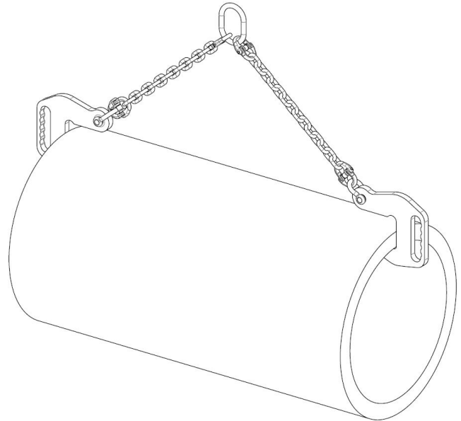
Crochets F montés sur élingues chaînes 2 brins
