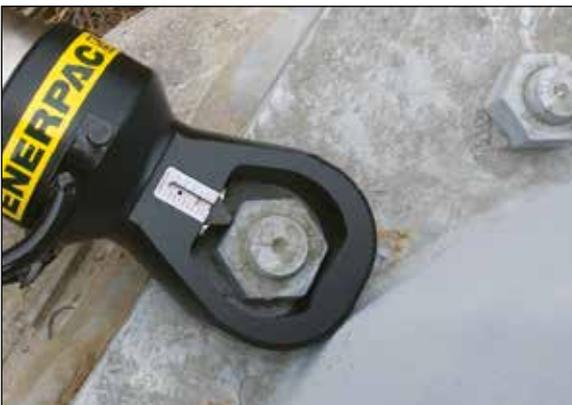
Ensemble de casse-écrous pour séparer les brides lors de travaux d'inspection, d'entretien et de démantèlement. ▶
