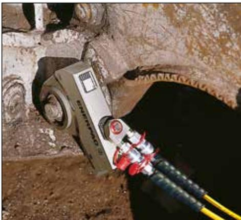
◀ Pour un entretien sur le terrain aisé et fiable grâce aux clés dynamométriques Enerpac série HXD.
