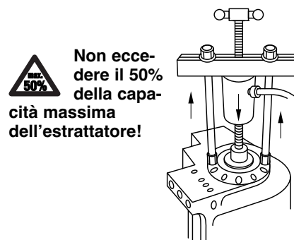
figura 3 - Calettare con estrattore a tiranti
