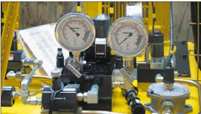
◀ Pour lever ou presser, toujours installer un manomètre. Le manomètre est la « fenêtre » du système, il permet de voir ce qui se passe.
