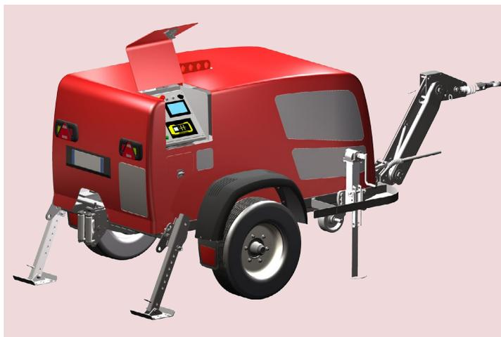
Treuil hydraulique conçu pour le tirage d'une câblette dans la pose de câbles de transport souterrains et câbles à fibre optique. Un circuit hydraulique permet de varier en continu la vitesse dans les deux directions en agissant sur un seul dispositif de contrôle.
