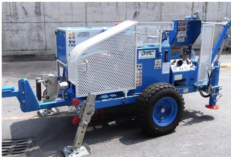
Treuil hydraulique conçu pour le tirage d'une câblette dans la pose de câbles de transmission souterrains.
