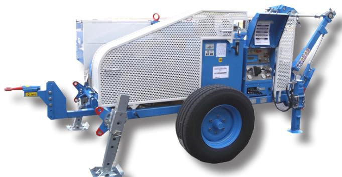
**Treuil hydraulique conçu pour le tirage d'une câblette dans la pose de câbles de transmission souterrains. Un circuit hydraulique permet de varier en continu la vitesse dans les deux directions en agissant sur un seul dispositif de contrôle.**
