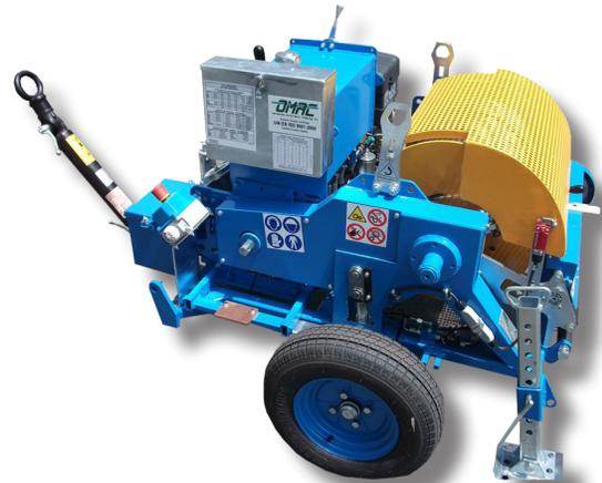
Treuil hydraulique conçu pour le tirage d'une câblette au cours des opérations de service telles que les montages, les régulations et la pose de câbles souterrains. Tirage direct sur le tambour. Un circuit hydraulique fermé permet la variation continue de la vitesse dans les deux sens de rotation à travers un seul levier de commande.
