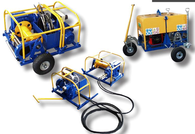
Treuil hydraulique conçu pour le tirage d'une câblette au cours des opérations de service et de pose de câbles souterrains. Le treuil est démontable en 2 modules. Un circuit hydraulique fermé permet la variation continue de la vitesse dans les deux sens de rotation à travers un seul levier de commande.
