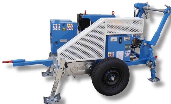
**Treuil hydraulique conçu pour le tirage d'une câblette dans le déroulage de lignes électriques de transmission aériennes. Un circuit hydraulique fermé permet de varier en continu la vitesse de rotation des cabestans dans les deux directions en agissant sur un seul dispositif de contrôle.**
