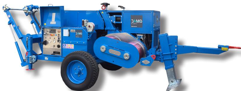
**Treuil hydraulique conçu pour le tirage d'une câblette dans le déroulage de lignes électriques de transmission aériennes. Un circuit hydraulique fermé permet de varier en continu la vitesse de rotation des cabestans dans les deux directions en agissant sur un seul dispositif de contrôle.**
