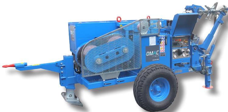
**Treuil hydraulique conçu pour le tirage d'une câblette dans le déroulage de lignes électriques de transmission aériennes. Un circuit hydraulique fermé permet de varier en continu la vitesse de rotation des cabestans dans les deux directions en agissant sur un seul dispositif de contrôle.**
