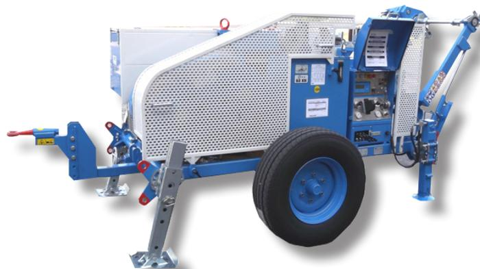
**Treuil hydraulique conçu pour le tirage d'une câblette dans le déroulage de lignes électriques de transmission aériennes. Un circuit hydraulique fermé permet de varier en continu la vitesse de rotation des cabestans dans les deux directions en agissant sur un seul dispositif de contrôle.**
