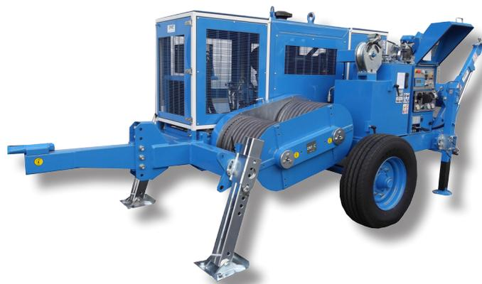
**Treuil hydraulique conçu pour le tirage d'une câblette dans le déroulage de lignes électriques de transmission aériennes. Un circuit hydraulique fermé permet de varier en continu la vitesse de rotation des cabestans dans les deux directions en agissant sur un seul dispositif de contrôle.**
