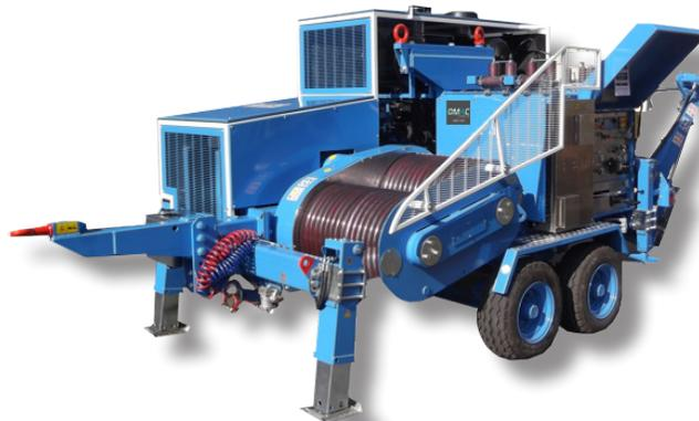
**Treuil hydraulique conçu pour le tirage d'une ou deux câbles dans le déroulage de lignes électriques de transmission aériennes. Deux circuits hydrauliques fermés permettent de varier en continu la vitesse de rotation des cabestans dans les deux directions en agissant sur deux dispositifs de contrôle indépendants. Les deux circuits peuvent être également jumelés et contrôlés ensemble par un seul dispositif de contrôle.**
