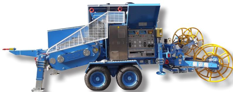
**Treuil hydraulique conçu pour le tirage d'une ou deux câbles dans le déroulage de lignes électriques de transmission aériennes. Deux circuits hydrauliques fermés permettent de varier en continu la vitesse de rotation des cabestans dans les deux directions en agissant sur deux dispositifs de contrôle indépendants. Les deux circuits peuvent être également jumelés et contrôlés ensemble par un seul dispositif de contrôle.**
