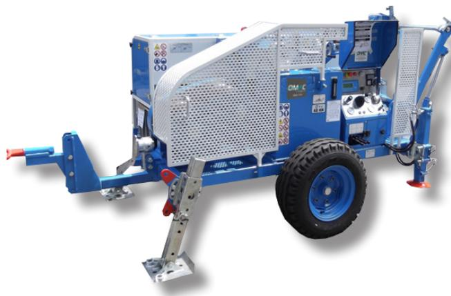
**Treuil hydraulique conçu pour le tirage d'une câblette dans le déroulage de lignes électriques de transmission aériennes. Un circuit hydraulique fermé permet de varier en continu la vitesse de rotation des cabestans dans les deux directions en agissant sur un seul dispositif de contrôle.**
