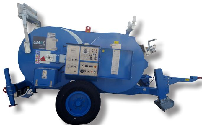
**Machine hydraulique conçue pour travailler soit comme freineuse soit comme treuil, adaptée pour le tirage d'1, 2, 3 ou 4 câbles ou pour le déroulage d'1, 2, 3 ou 4 conducteurs. Un circuit hydraulique permet d'appliquer une force de freinage constante même à la variation de la vitesse de déroulage. En fonction treuil, un circuit hydraulique fermé permet de varier la vitesse dans les deux directions.**
