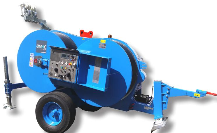
**Machine hydraulique conçue pour travailler soit comme freineuse soit comme treuil, adaptée pour le tirage d'une ou deux câbles ou pour le déroulage d'un ou deux conducteurs. Un circuit hydraulique permet d'appliquer une force de freinage constante même à la variation de la vitesse de déroulage. En fonction treuil, un circuit hydraulique permet de varier la vitesse dans les deux directions.**
