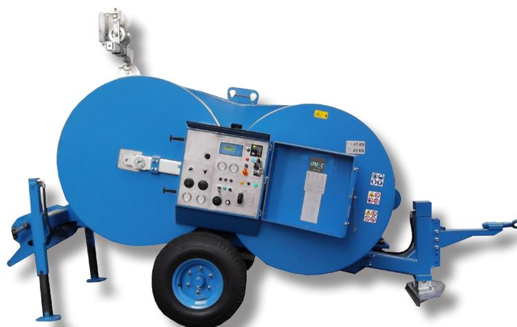
**Machine hydraulique conçue pour travailler soit comme freineuse soit comme treuil, adaptée pour le tirage d'une ou deux câbles ou pour le déroulage d'un ou deux conducteurs. Un circuit hydraulique permet d'appliquer une force de freinage constante même à la variation de la vitesse de déroulage. En fonction treuil, un circuit hydraulique permet de varier la vitesse dans les deux directions.**
