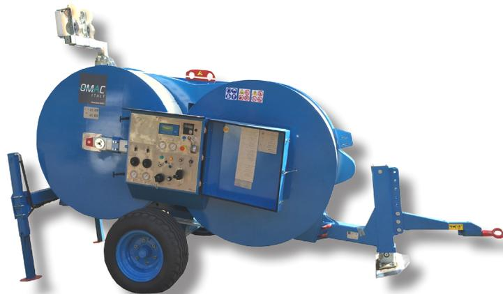
**Machine hydraulique conçue pour travailler soit comme freineuse soit comme treuil, adaptée pour le tirage d'une câblette ou pour le déroulage d'un conducteur. Un circuit hydraulique permet d'appliquer une force de freinage constante même à la variation de la vitesse de déroulage. En fonction treuil, un circuit hydraulique permet de varier la vitesse dans les deux directions.**
