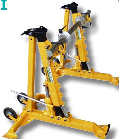
Vérins porte-tourets adaptés pour des tourets en acier ou en bois, conçus pour le levage d'un touret lors des opérations de déroulage de câbles. De plus il est possible, en option, d'installer un disque de frein pour freiner le câble. Les vérins sont fournis en paires.
