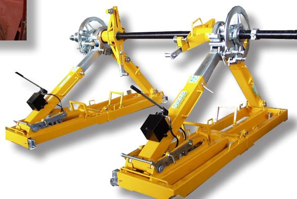
**Vérins porte-tourets adaptés pour des tourets en acier ou en bois, conçus pour le levage d'un touret et son freinage lors des opérations de déroulage de câbles. De plus il est possible, en option, d'entraîner le touret hydrauliquement par le biais d'une centrale de puissance.**
