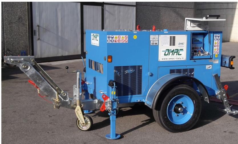
Treuil hydraulique conçu pour le tirage d'une câblette dans la pose de câbles de transmission souterrains et câbles à fibre optique. Un circuit hydraulique permet de varier en continu la vitesse dans les deux directions en agissant sur un seul dispositif de contrôle.
