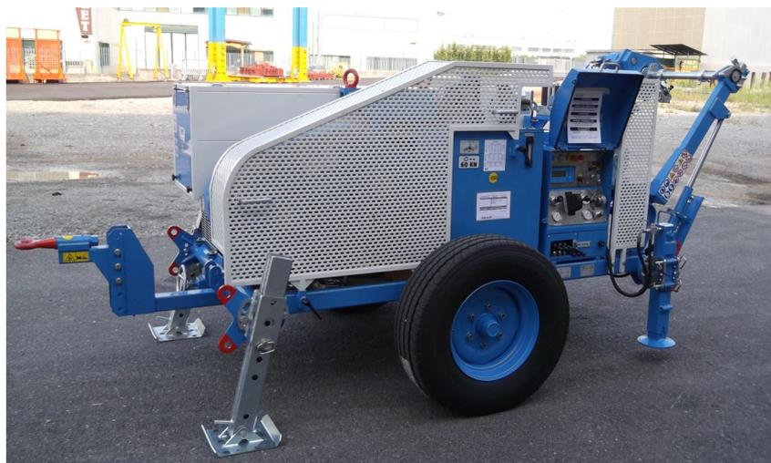
Treuil hydraulique conçu pour le tirage d'une câblette dans la pose de câbles de transmission souterrains.
