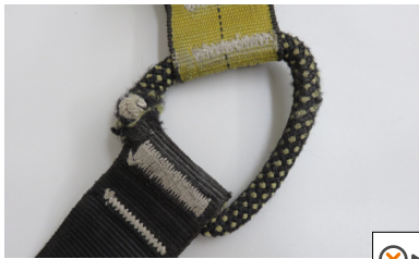
• Point d'encordement abîmé
