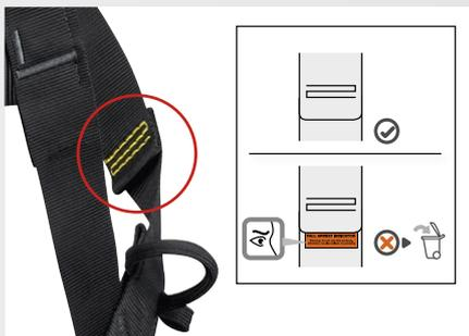
Les points d'attache sternal et dorsal sont équipés de témoins de chute : après la chute une sangle rouge apparaît, indiquant que le harnais doit être mis au rebut.
