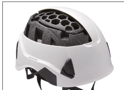
La coque interne des casques STRATO est conçue en deux parties : EPP (polypropylène expansé) et EPS (polystyrène expansé), afin d'offrir plus de légèreté. L'absorption des chocs est réalisée par déformation de la coque interne.
