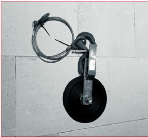
La poulie de mouflage permet d'accroître la CMU du treuil à câble passant type Tirak par 2. Il existe en parc de location 2 modèles : la MC2T et la MC4T pour respectivement le Tirak 1 tonne et le Tirak 2 tonnes.
