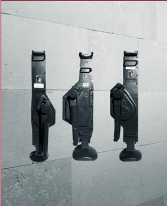
Une gamme des crics mécaniques fait partie de notre parc de location pour effectuer des opérations de levage à partir du sol. La charge peut être positionnée indifféremment sur la patte latérale ou sur la tête du cric. Le mouvement de montée ou de descente s'effectue par rotation de la manivelle. La vitesse de descente est régulée. Les appareils sont équipés d'une poignée pour être facilement déplacés.
