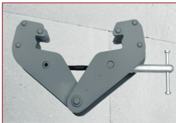
Une gamme de pinces ou griffes d'accrochage vous permettra d'offrir une solution d'accrochage rapide sur poutre acier. L'ouverture de la pince est réglable afin de pouvoir se positionner et s'ajuster aux différents profils du commerce. Son anneau permet de suspendre un appareil de levage muni d'un crochet.
