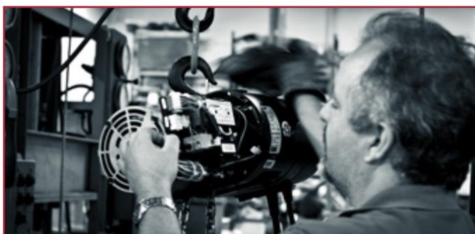
**2. Le contrôle semestriel ou annuel :** Il consiste à faire un diagnostic de l'appareil, ainsi que des tests sur banc d'essai afin d'observer l'état de conservation de l'appareil et de son fonctionnement.
