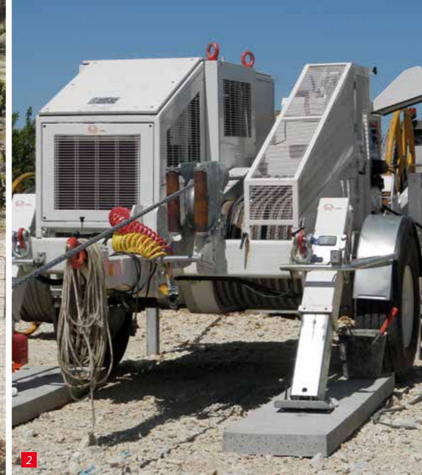
1 - C'est sur des bobines de 4,5 m de \phi et 5,5 m de large avec une masse de presque 90 t que les câbles électriques sont amenés sur le chantier. 2 - Deux treuils hydrauliques à double cabestan de 28 t et 20 t ont été mis à contribution pour ces opérations de tirage. 3 - Ce sont 2 fourreaux en PVC \phi 250 mm CR 16 qui sont mis en place pour chacune des deux liaisons.
